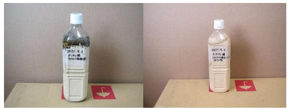
ソウジクロンを稼働する 前(左)と後(右)の切削液の 比較画像です。
