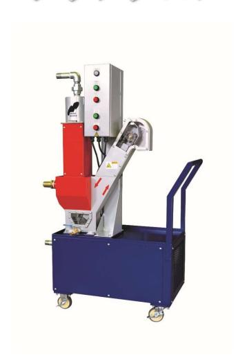
ソウジクロンは工作機械の下に設置されているタンク内の切削液をホースで吸い上げてその中に含まれる細かい切粉やスラッジ等を分離してキレイになった切削液をタンクに戻し、循環させて徐々にタンク内をキレイにしていく装置です。
